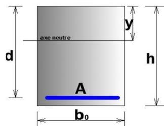
Figure 7: Poutre de section à simple armature
