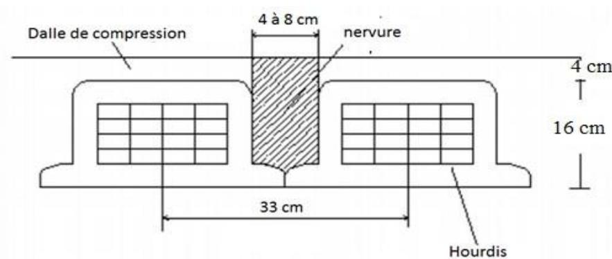
Figure 5: Dimensions du plancher
