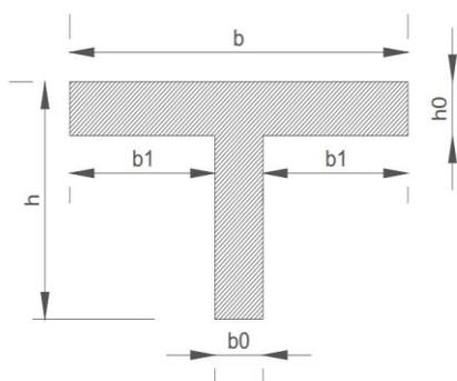
Figure 8: Dimensions des poutrelles
