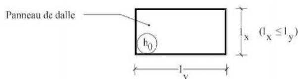
Figure 1 : Dimension du plancher
